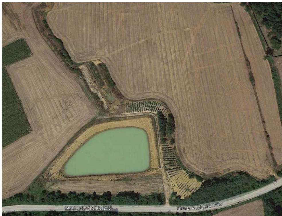
**Figura 2-3** – Foto aerea 2016. Subito dopo il rinnovo dell'autorizzazione la ditta ha provveduto a sistemare le scarpate dell'invaso e a effettuare le piantumazioni
